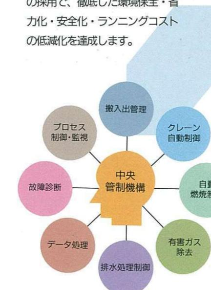
頭脳にあたる中央制御室では、プロセス・運転データなど施設内のあらゆる情報を集め、コンピュータにより自動的に集中管理します。
