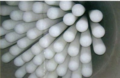
ろ過式集塵機内部 (内部を下から撮影)
