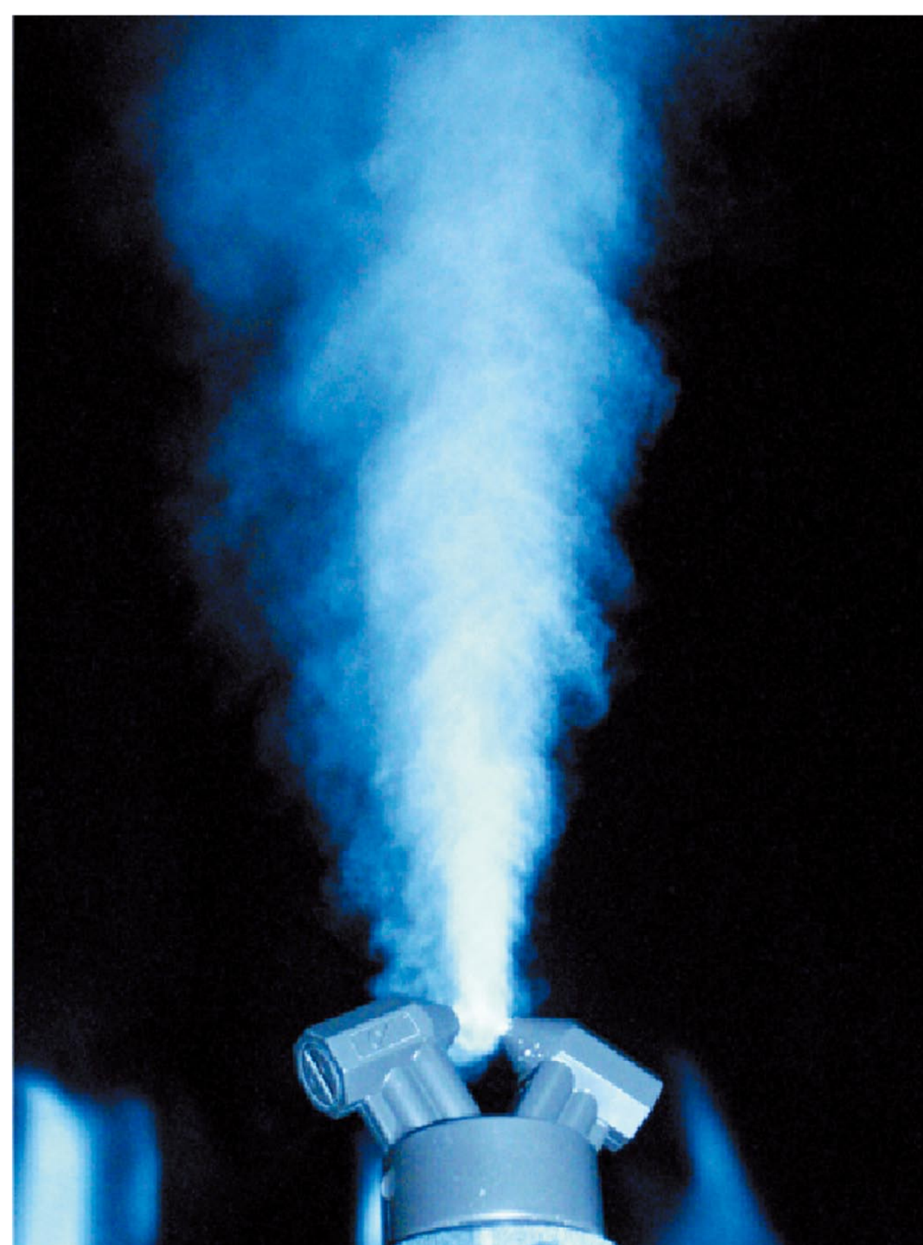
2 流体ノズル噴霧状況 (粒径10 \mu m)
