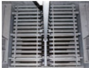
◀「エアロウイング」。槽形状に合わせ均等なパネルレイアウトが可能。
