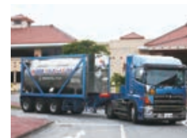
▲現在稼働中のトランスヒートコンテナ（24t）
