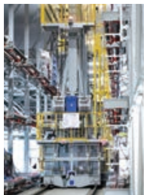
▲処理能力を向上させたETVが2台稼働
