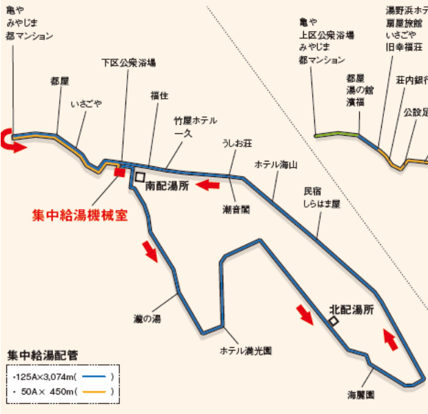
図1 集中給湯配管ルート
