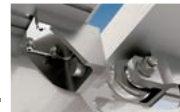
▶カート同士をつなぐリンク部の ねじれ対応構造
